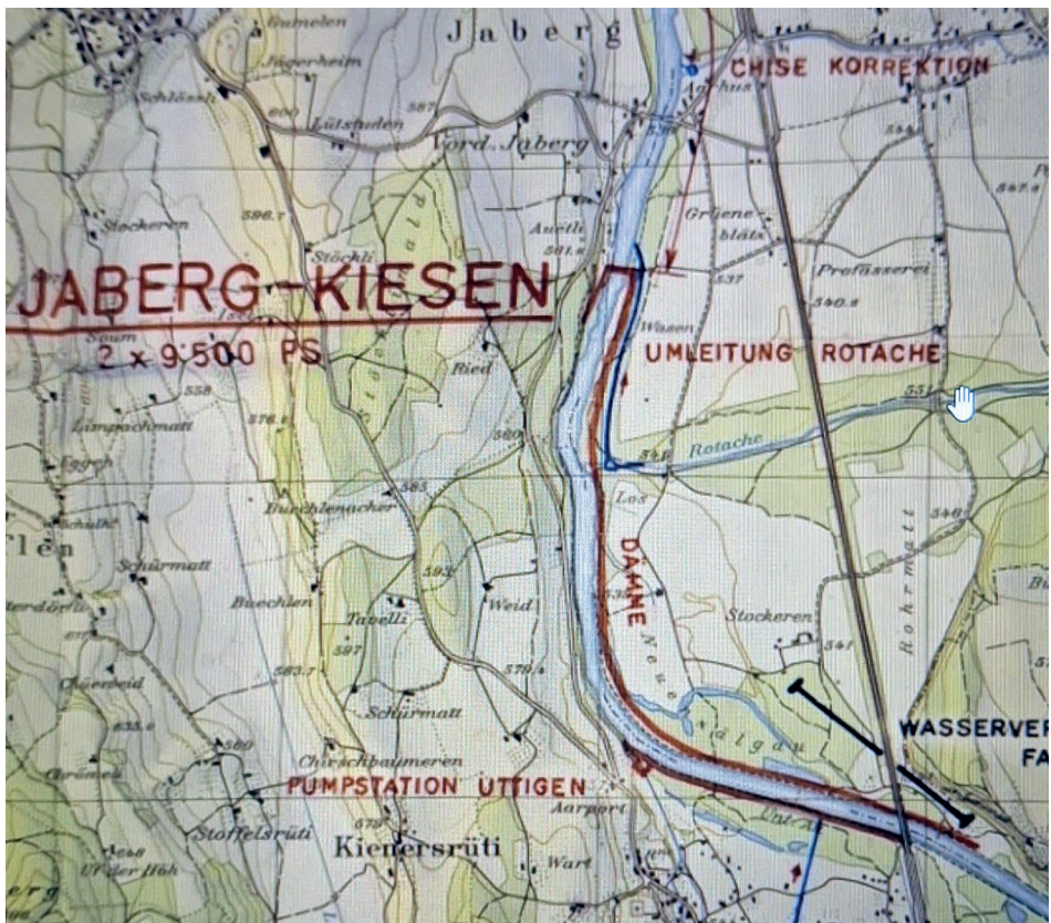
Auszug einer 25'000er Karte, rot eingezeichnet die geplanten Dämme, blau eingezeichnet die Umleitung der Rotache.
